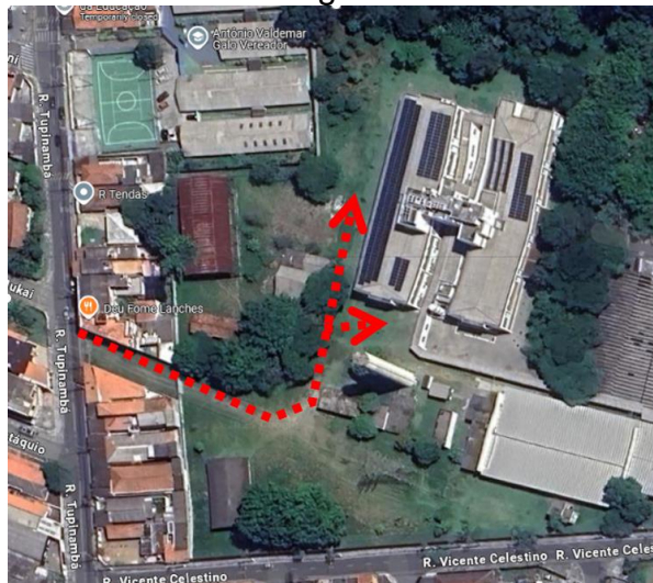
Fig – Acesso para guindaste e patolamento
